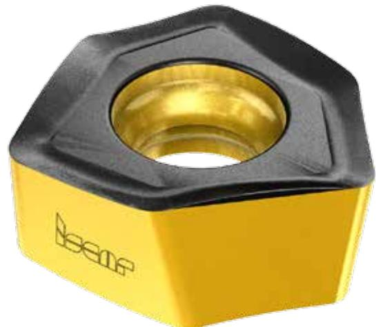
ヘリカル切刃採用により、切削抵抗の減少を実現します。また、強固なクランプを実現するダブルテイル形状です。ヘリドウ・アップフィードシリーズは、平面加工・3次元加工・溝加工・キャビティ加工等、幅広い加工用途に対応し、高い効果を発揮します。
