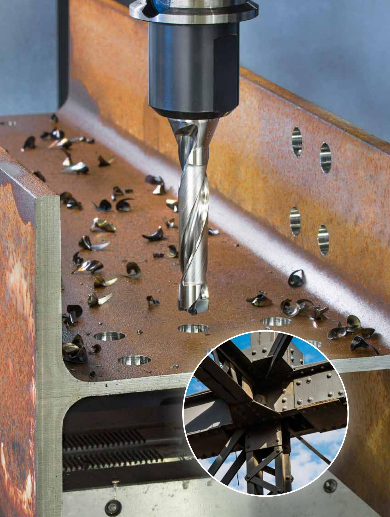
イスカルのカムIQドリルとスモウカムIQは、ビームとフレームの穴あけ加工において優れた性能を発揮します。湾曲した独創的な切刃形状により、セルフセンタリング機能を搭載し、下穴加工が不要となります。また高精度仕上げが可能なため、バリ取りが不要となります。多くの場合、ビームの穴あけ加工時にはクーラントの供給が問題となり、ドライ加工もしくはそれに準ずる加工が推奨されます。カムIQドリル・スモウカムIQは、MQLでの最小のクーラント供給での加工にも適しています。
