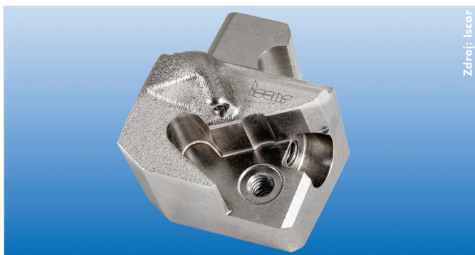
Obr. 2. Hlavice modulárního systému Neoswiss pro stroje švýcarského typu, rychle vyměnitelná hlavice vytvořená technologií 3D tisku.
